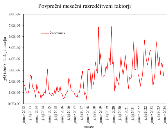
Slika 4.8: Povprečni mesečni razredčitveni koeficienti ( \chi/Q ) z enoto s/m^3 , izračunani po Lagrangeevem modelu za izpust z višine 60 m za okolico NEK za leta 2013–2023.
