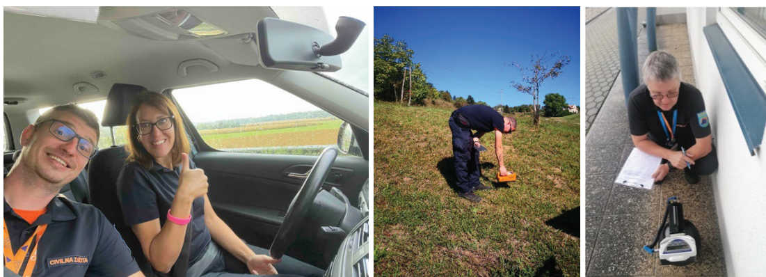
Slika S4: Izvajanje nalog na terenu: pozitivno vzdušje v avtomobilu med iskanjem naslednje merske točke v okolici Krškega ( levo ); izvajanje meritev hitrosti okoljskega doznega ekvivalenta in površinske kontaminacije na različnih lokacijah ( sredina ); izvedba meritev hitrosti doze nevtronov na območju NEK ( desno ).
