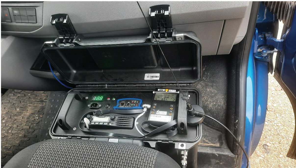
Slika 13: Izvajanje meritev hitrosti doz s sporočanjem terenskih rezultatov s postajo ZARE+
