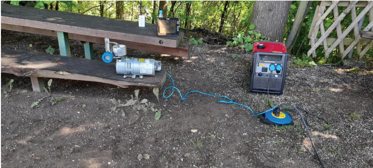
Slika 9: Vzorčenje zraka z nizko pretočno prenosno zračno črpalko F&J LV-1E
