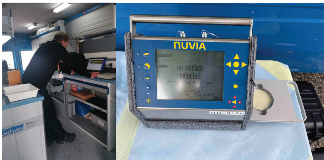
Slika S1: Meritve na terenu: Prikaz meritve spektrometrije gama v mobilnem laboratoriju ( levo ) in izvedba meritve skupne aktivnosti beta filtrskega papirja na brisu z merilnikom WIMP ( desno ).
